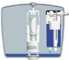
Le réservoir se vide plus rapidement que le boîtier retardateur, tandis que le robinet flotteur est toujours fermé.
