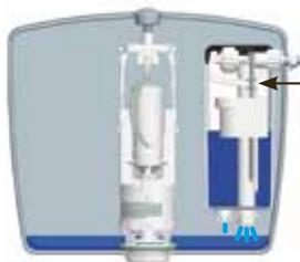
Une fois le réservoir vide, le mécanisme se referme, le boîtier retardateur continue à se vider et le robinet flotteur s'ouvre pour remplir le réservoir
